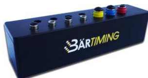
HUB (Verteiler) für zusätzliche Sensoren und PC-Ausgang
